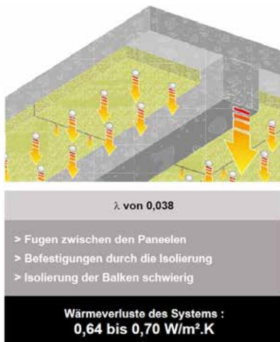
Unter den betrachteten Annahmen sind die Wärmeverluste des mit FIBREXPAN® isolierten Systems bis zu 34 % geringer als die von Dämmstoffen aus Steinwollplatten. Metallbefestigungen und Fugen zwischen den Platten erzeugen integrierte Wärmebrücken.
